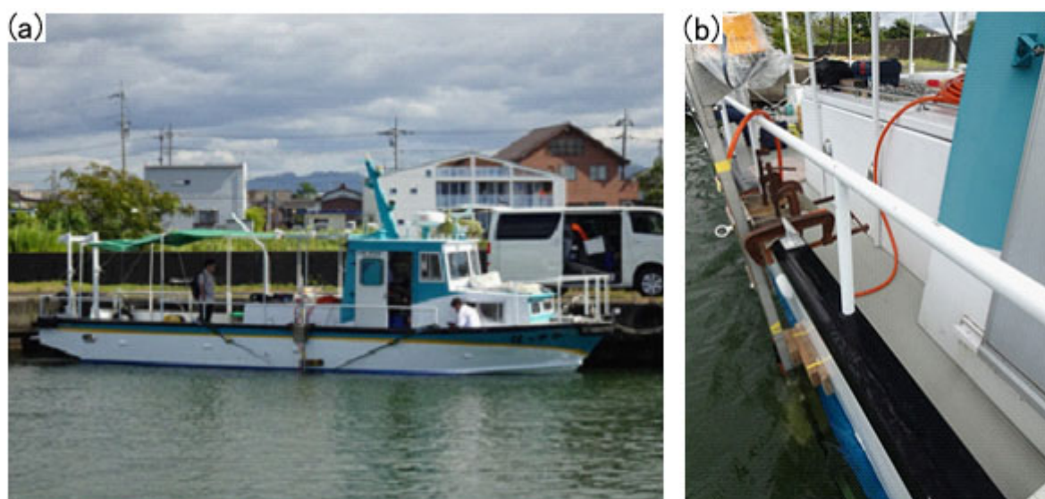
図 2 (a)「はっさか」右舷中央部に SBP を艀装した。 (b) 艀装した SBP の様子。オレンジ色筐体は動揺センサー。送受波器は水中に没した状態となっている。
