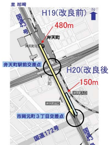
図 2.5.5 市岡元町3丁目交差点の改良工事前後の渋滞状況の比較 26)
